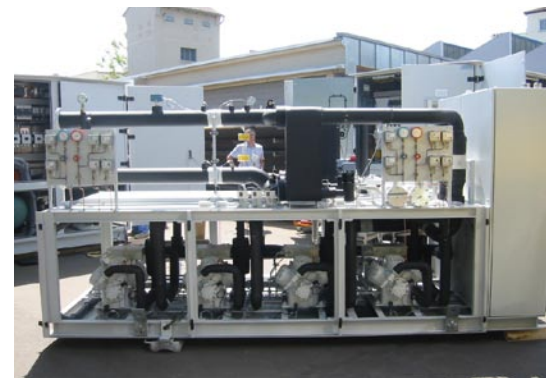
Verbundwärmepumpe mit Kolbenverdichtern
