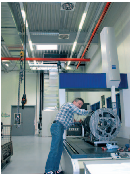
Qualitätskontrolle im Bitzer-Werk: Die Präzision in der Fertigung konnte gegenüber einer nicht klimatisierten Produktion um den Faktor 8 bis 10 gesteigert werden.
